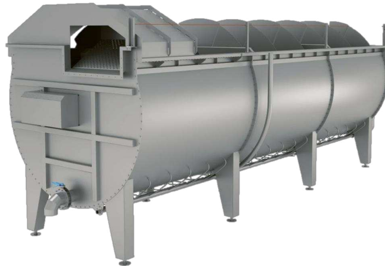
Figura 5 - Chiller de imersão em água para carcaças de frango
