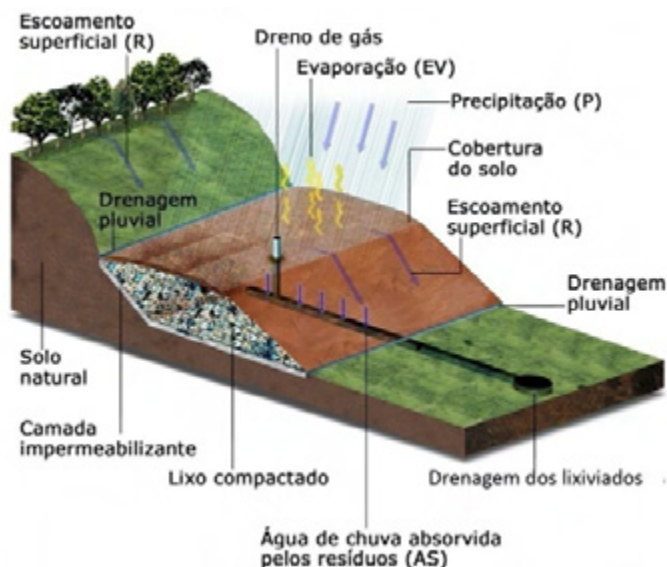
Figura 9 – Esquema da formação dos líquidos lixiviados Fonte: Fundação Estadual do Meio Ambiente, 2007.
