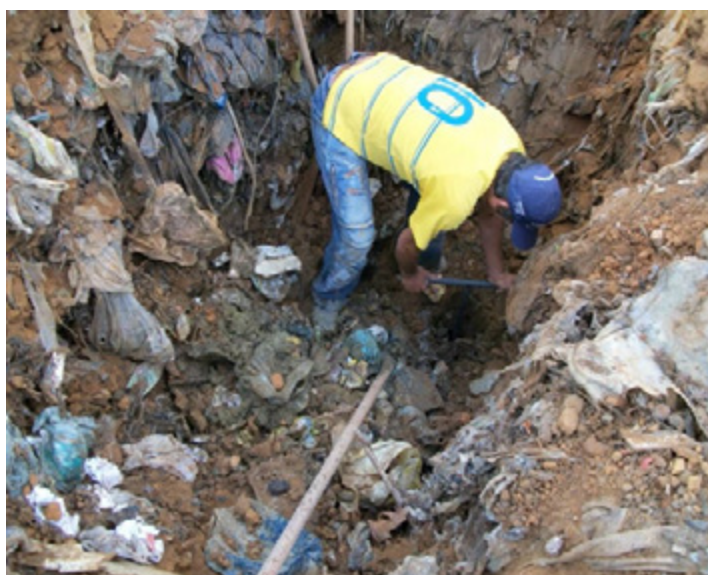
Figura 28 – Coleta de amostra de solo sob a vala de disposição de resíduos com utilização de trado manual.
