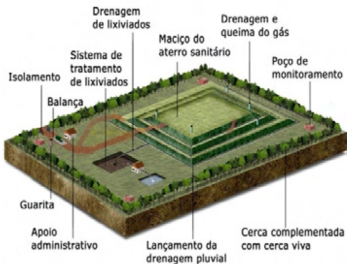
Figura 8 – Aterro Sanitário de Pequeno Porte em área.
