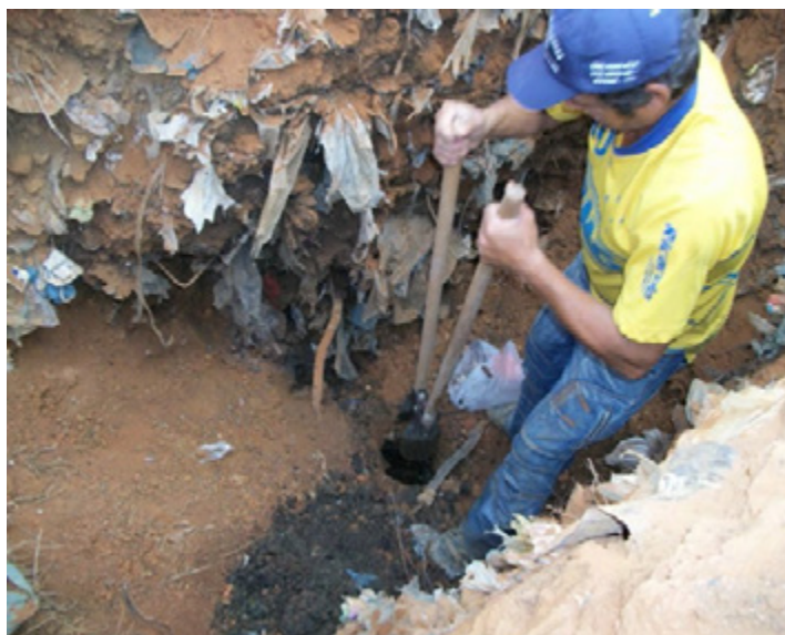
Figura 27 – Coleta de amostra de solo sob a vala de disposição de resíduos com utilização de cavadeira tipo boca de lobo.
