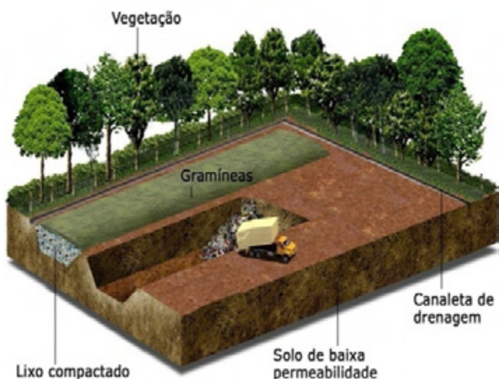
Figura 5 – Aterro Sanitário de Pequeno Porte em valas. Fonte: Fundação Estadual do Meio Ambiente, 2011.
