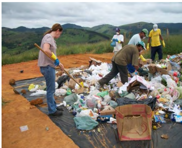
Figura 18 – Rompimento das embalagens e mistura para homogeneização dos resíduos.
