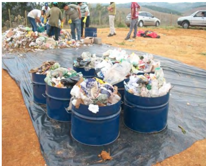
Figura 19 – Acondicionamento das amostras em tambores.
