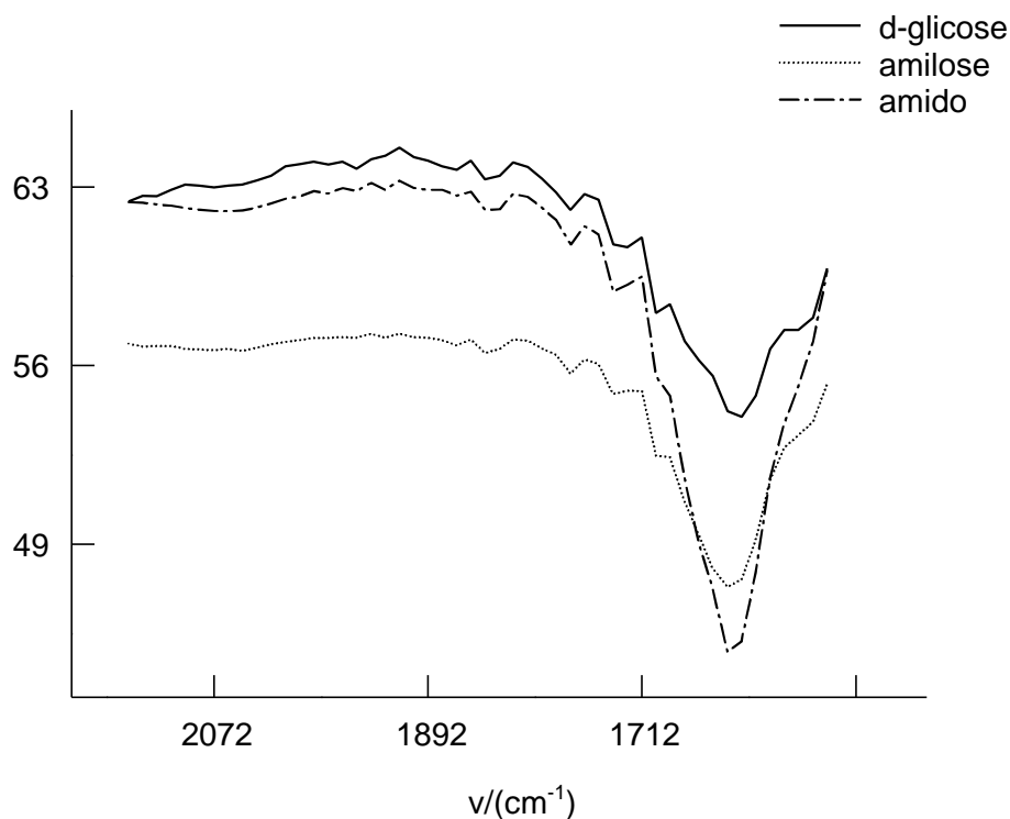
Figura 17 - Espectro do infravermelho da molécula de D-glicose, da macromolécula de amilose e do grão de amido em pó, na região de 1.780 - 1.565 \text{cm}^{-1} .
