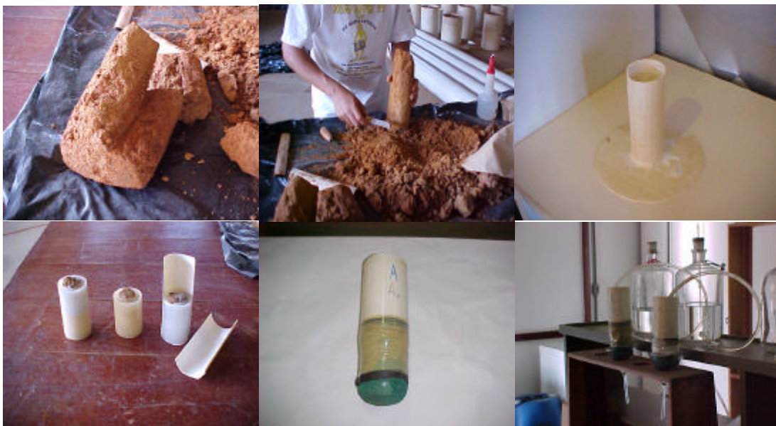
Figura 2.3.5 – Preparação e montagem de colunas indeformadas de solo e montagem do permeômetro de carga constante para determinação da condutividade hidráulica e dos parâmetros de transporte
