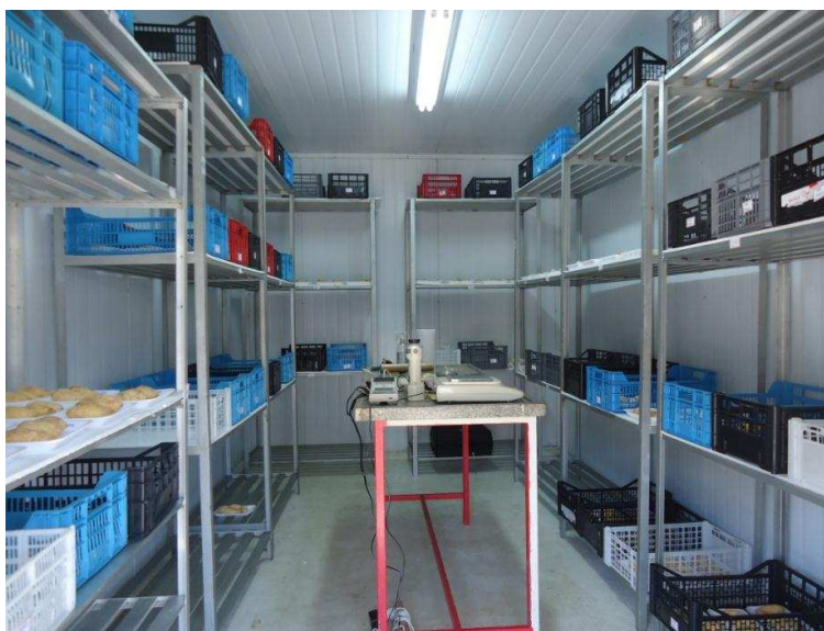
Figura 6 - Baroas acondicionadas em câmara climática a 23 \pm 2 \text{ }^\circ\text{C} e 85 \pm 5\% de umidade relativa.
