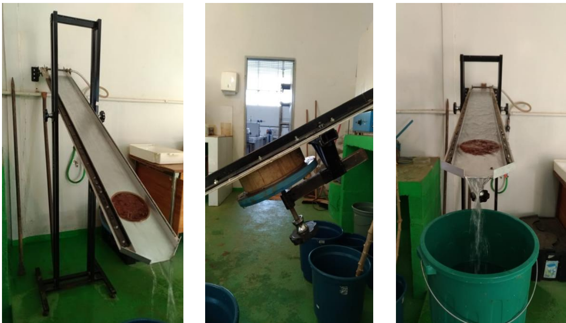
Figura 3. Detalhes do equipamento de Inderbitzen utilizado na determinação da erodibilidade.
