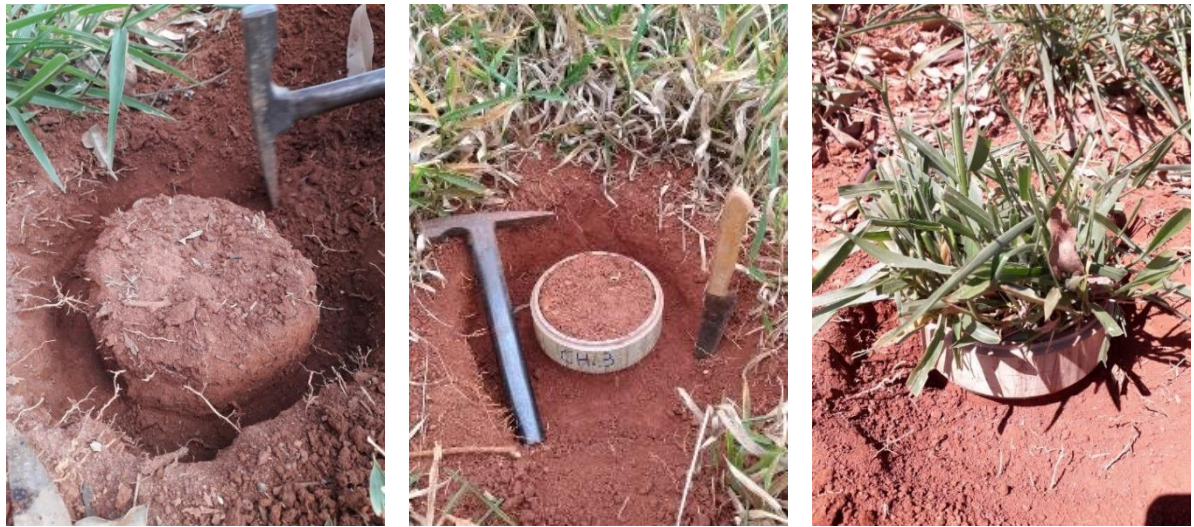
Figura 2. Procedimentos realizados em campo para a coleta das amostras indeformadas sem e com cobertura da pastagem.
