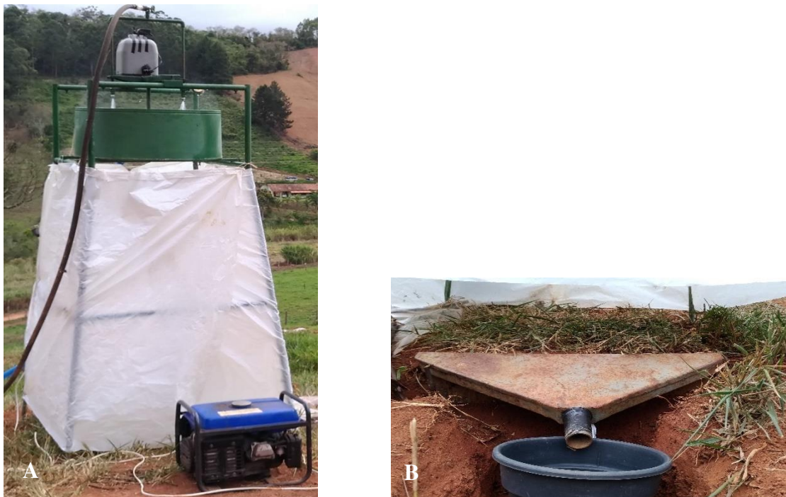
Figura 1. Infiltrômetro de aspersão utilizado para simular chuvas artificiais (A) e detalhe de calha coletora de escoamento superficial (B).
