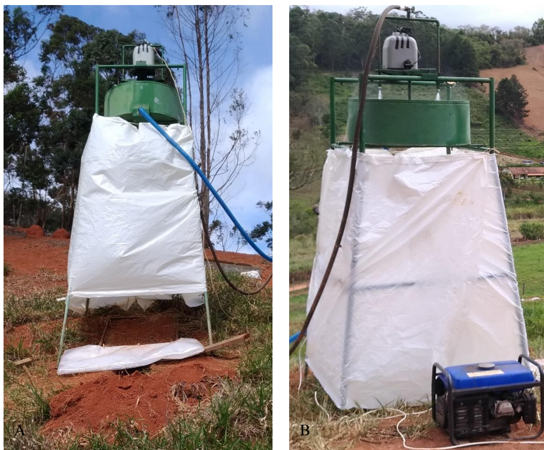
Figura 3. Simulador de chuvas instalado em área íngreme (A) e detalhe da lona plástica colocada para redução de perdas da lâmina precipitada (B).
