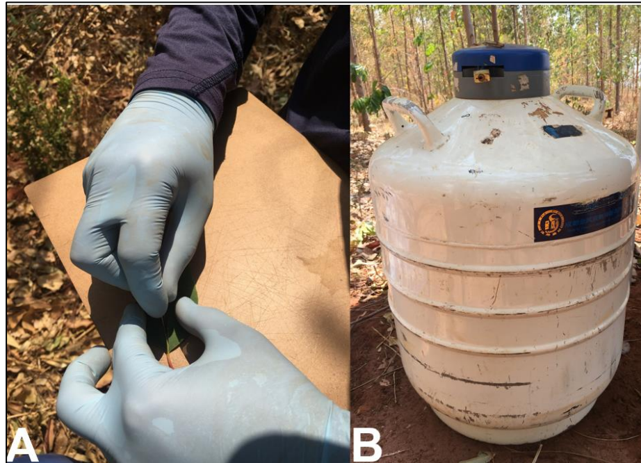
Figura 6 - Material para determinação de teores das Chl a e Chl b . A - Coleta de amostra central da folha; B - Armazenamento em nitrogênio líquido para posterior análise em laboratório.
