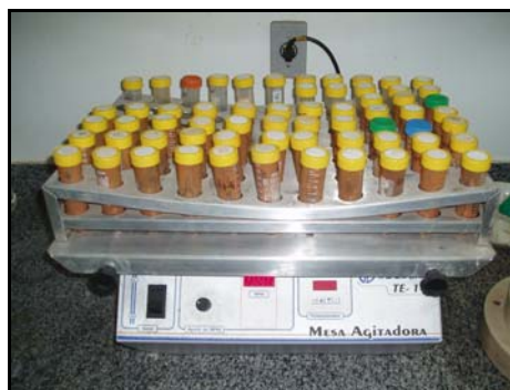
Figura 3.22 – Mesa agitadora orbital - Modelo TE 140 – TECNAL - Lab. de Geotecnia Ambiental DEC/UFV
