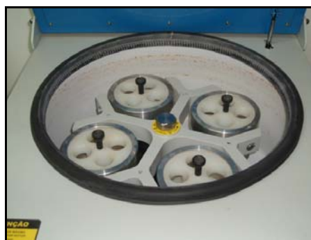
Figura 3.23 – Centrífuga Modelo CT 6000 - CIENTEC – Lab. de Geotecnia Ambiental DEC/UFV
