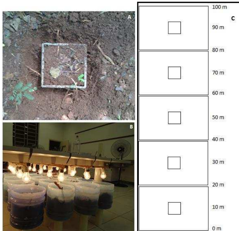
Figura 5 – Método de coleta da serapilheira e do solo para amostragem da macrofauna edáfica. A – Gabarito para coleta das amostras de solo + serapilheira; B – Funis de Berlesse adaptados, confeccionados com galões de plástico para armazenamento de água, contendo amostras de solo e serapilheira. C – Desenho esquemático de um transecto com suas respectivas parcelas e a localização da área em que as amostras de solo + serapilheira foram coletadas para cada parcela.
