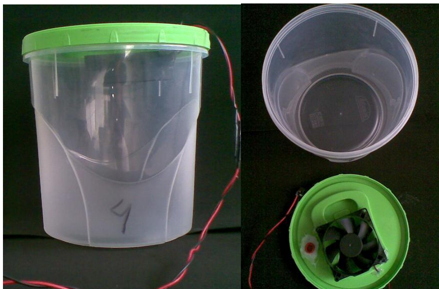
Figura 4 - Frasco plástico hermético, dotados de uma ventoinha acoplada à parte interior da tampa, utilizado para determinação da produção de \text{CO}_2 dos mamões ozonizados.
