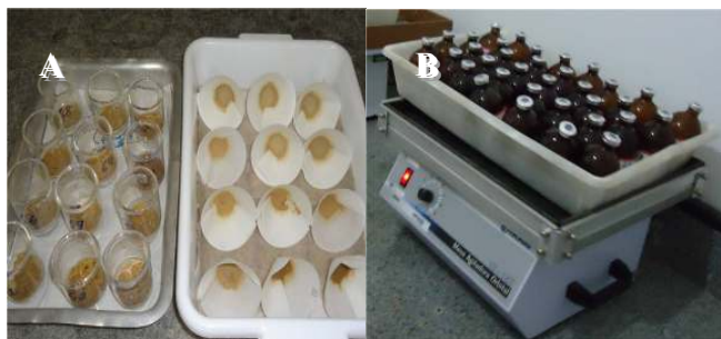
Figura 4. Degradação de carboidratos fibrosos. A- Resíduos para determinação da CIDN e da PIDN; B- Mesa de agitação orbital
