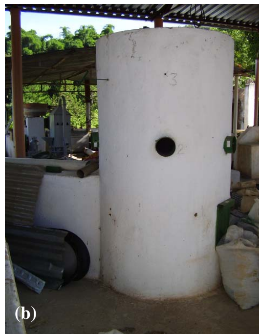
Figura 05. Mufla(a) e Gaseificador(b) usado para a queima do bagaço da cana-de-açúcar
