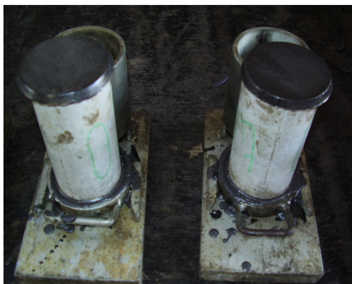
Figura 16. Capeamento dos corpos-de-prova.
