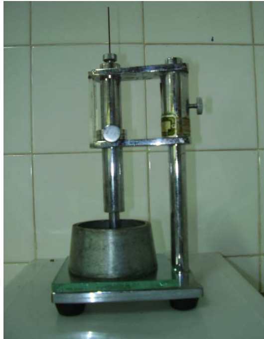
Figura 11. Aparelho de Vicat usado para realização do ensaio de tempo de pega inicial e final.
