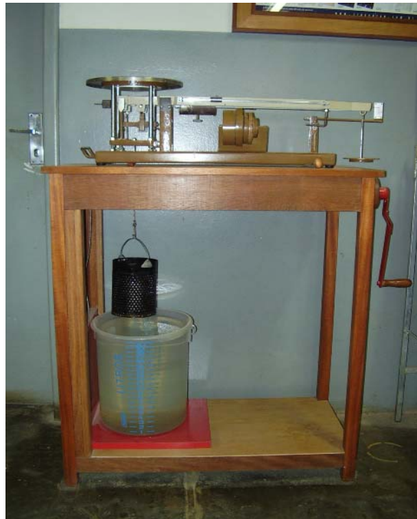
Figura 18. Ensaio de absorção de água por imersão, índice de vazios e massa específica.
