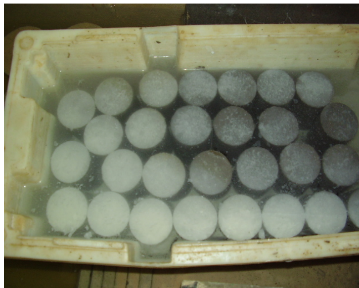
Figura 14. Corpos-de-prova submetidos à cura com cal.
