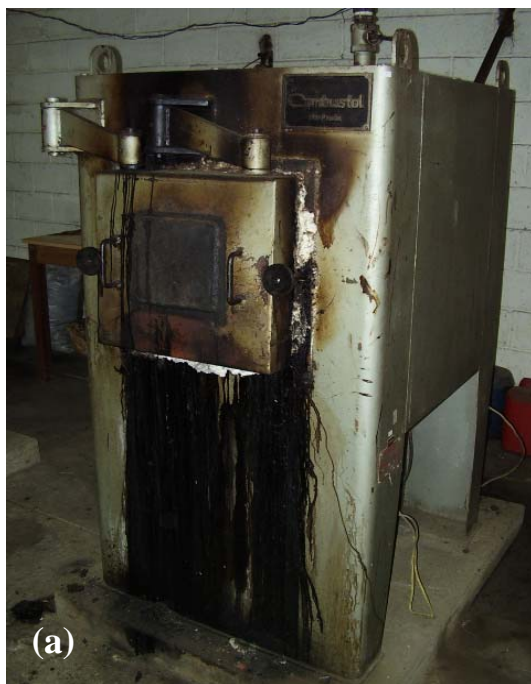
Figura 05. Mufla(a) e Gaseificador(b) usado para a queima do bagaço da cana-de-açúcar
