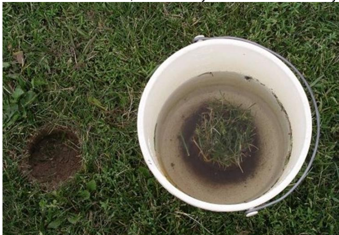
Figura 5: Imagem exemplificando a utilização do método de amostragem por flotação. Adaptado de Penn State Extension, The Pennsylvania State University
