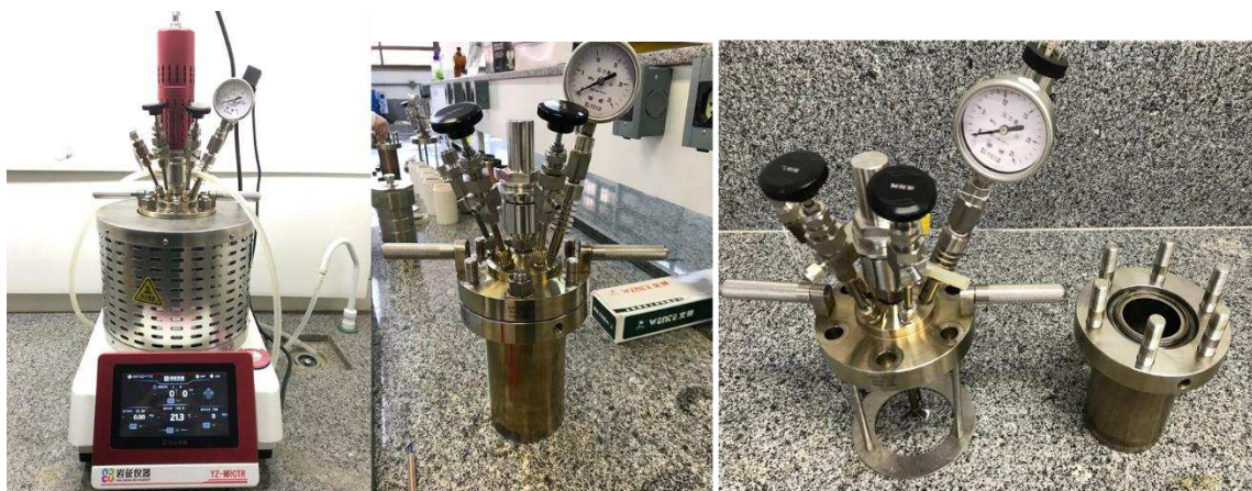
Figura 16. Componentes e estrutura do reator de alta pressão
