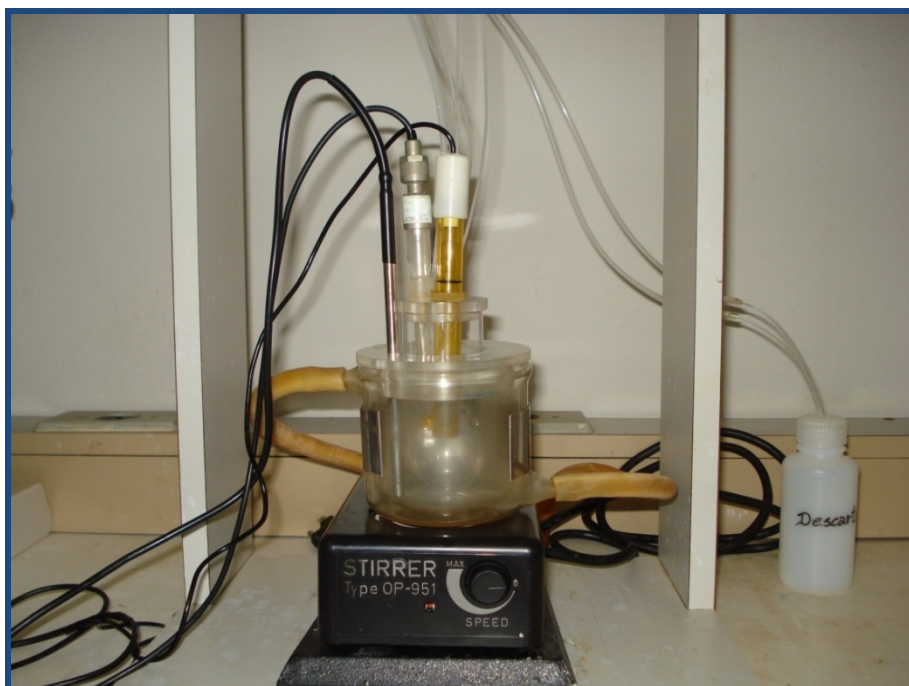
Figura 10. Cella utilizada para determinação de paracetamol.
