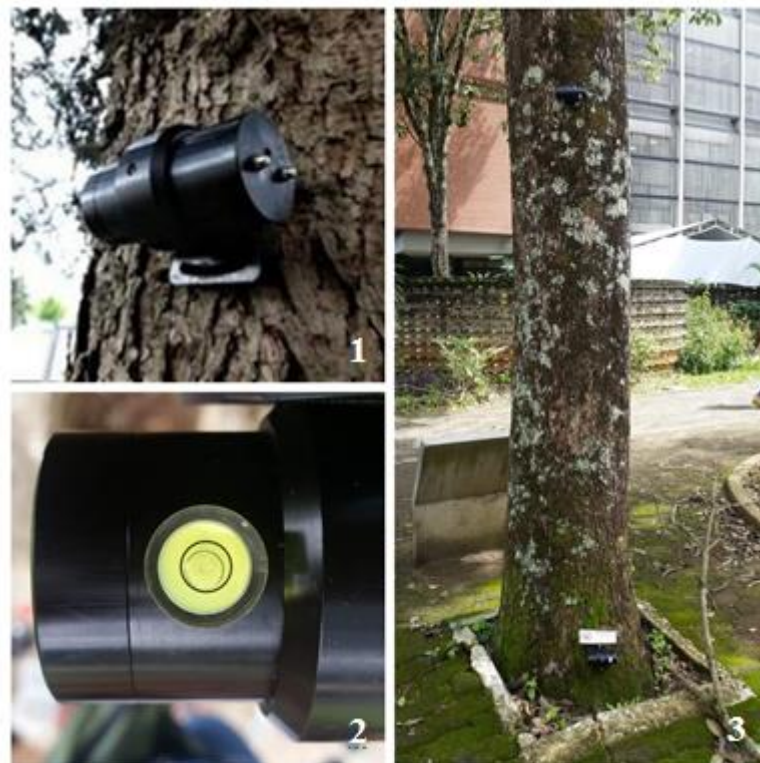
DADOS: 1 – Sensor TMS; 2 – Bolha de nível no sensor; 3 – Sensores de base e controle instalados na árvore. Fonte: A autora (2019)
