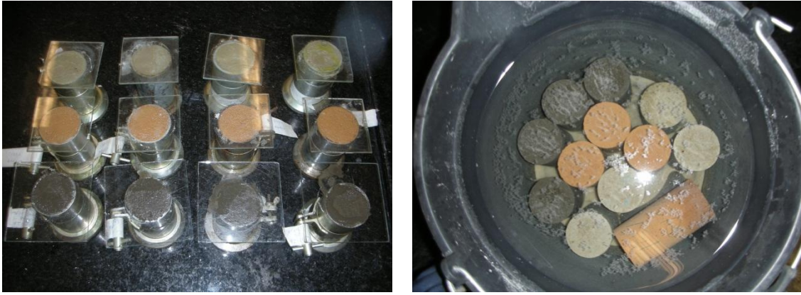
(a) (b) Figura 3.16 – (a) Corpos-de-prova logo após a moldagem; (b) Corpos-de-prova imersos em água saturada de cal para cura
