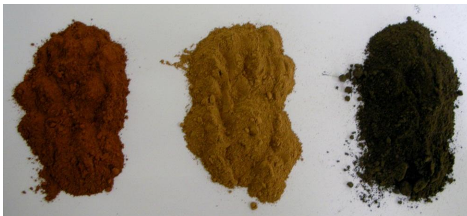
Figura 3.8 – (a) Cinza proveniente da queima do bagaço por processo não industrial tratada quimicamente (CT); (b) Cinza proveniente da queima do bagaço por processo não industrial (CBC); (c) Cinza proveniente da queima do bagaço por processo industrial (US)
