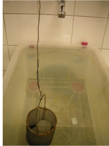
Figura 3.17 – (a) Equipamentos usados para realização do ensaio para determinação da absorção de água de corpos-de-prova de argamassa com e sem adição de cinza; (b) Corpo-de-prova imerso em água para determinação da absorção de água
