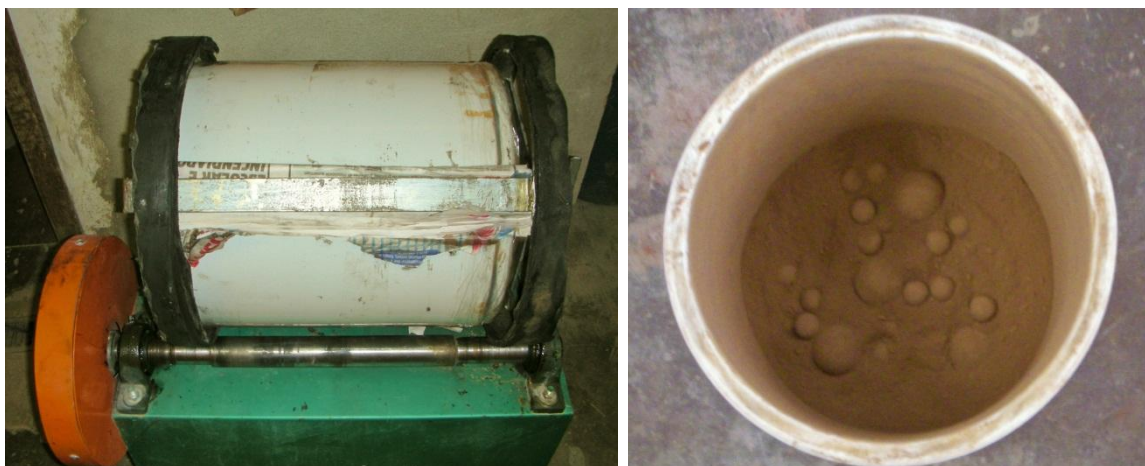
Figura 3.7 – (a) Moinho rotativo; (b) Cinza e esferas moedoras dentro do cilindro para moagem
