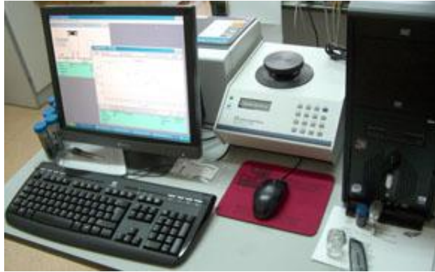
Figura 3.9 – Picnômetro a gás hélio usado para determinação da densidade real das cinzas
