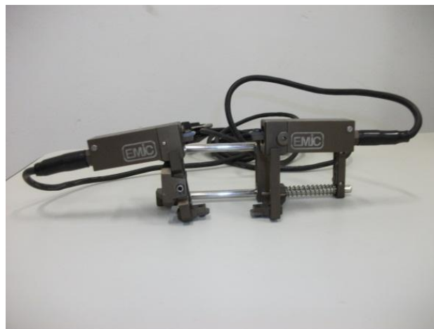
Figura 3.22 – Extensômetro eletrônico usado para medição de deformação de corpos-de-prova de concreto
