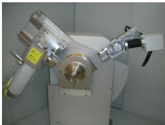
Figura 3.10 – Equipamento usado no ensaio de difração de raios – X para determinação da presença ou não de fases cristalinas no material pozzolânico
