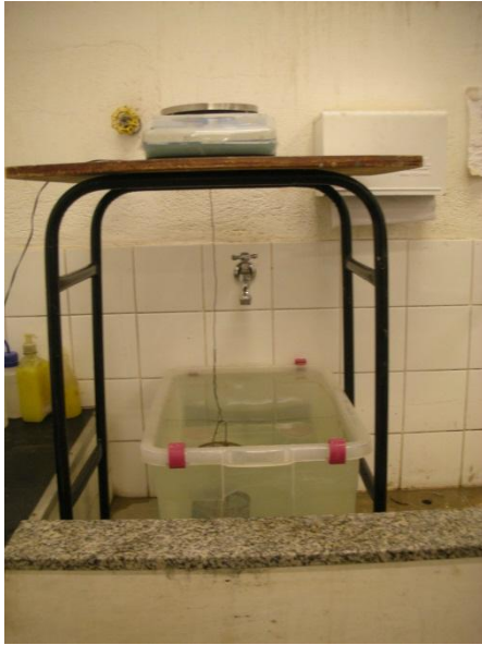
Figura 3.17 – (a) Equipamentos usados para realização do ensaio para determinação da absorção de água de corpos-de-prova de argamassa com e sem adição de cinza; (b) Corpo-de-prova imerso em água para determinação da absorção de água
