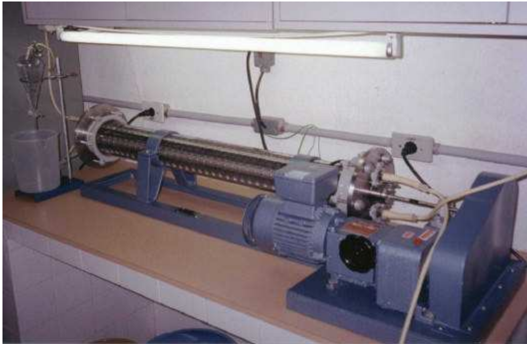
Figura 3.1 - Montagem experimental do Extrator Graesser.
