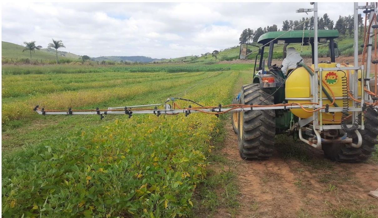
Figura 2. Ilustração do sistema de pulverização utilizado no experimento.
