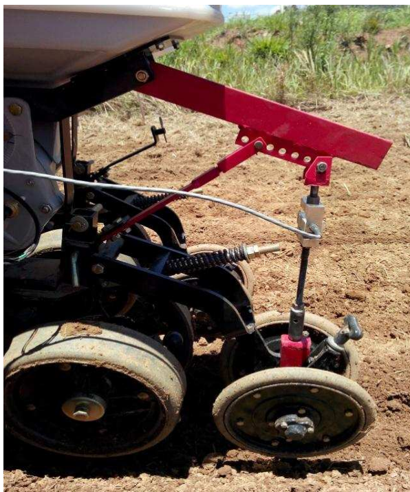
Figura 7 – Suporte com a célula de carga instalada na roda compactadora.
