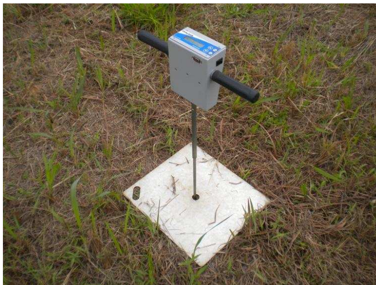
Figura 2 – Penetrômetro digital utilizado no experimento.
