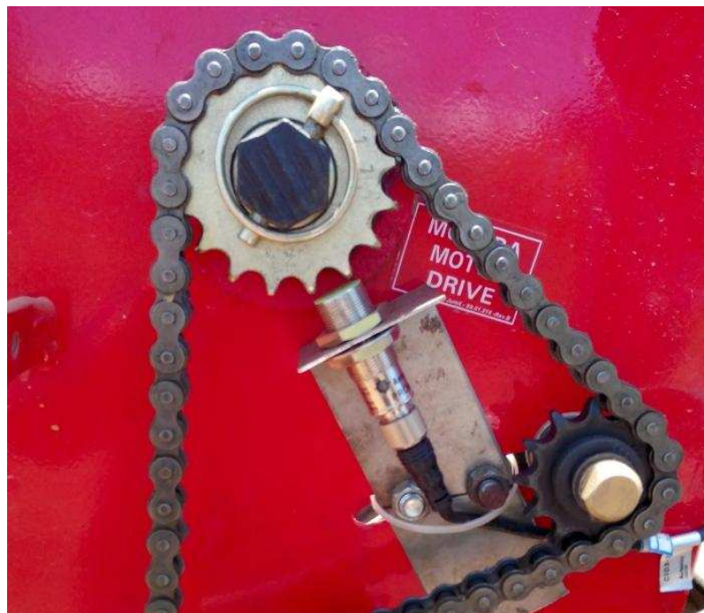
Figura 6 - Transdutor associado à engrenagem motora do mecanismo dosador.
