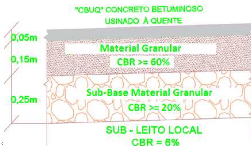
Figura 24 – Estrutura para o pavimento da via proposta.
