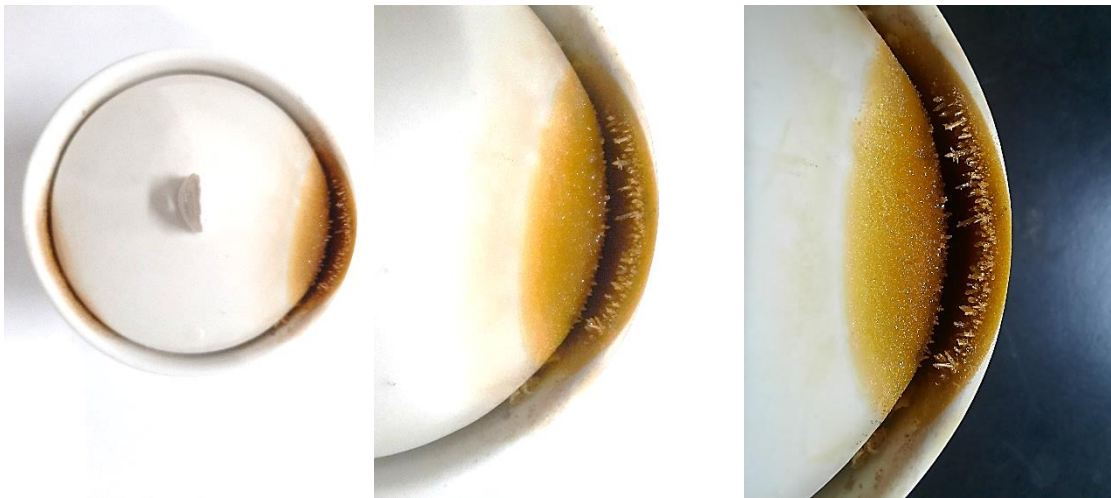
Figura 2.4: Formação de cristais nos orifícios de saída do cadinho. Fonte: O Autor.
