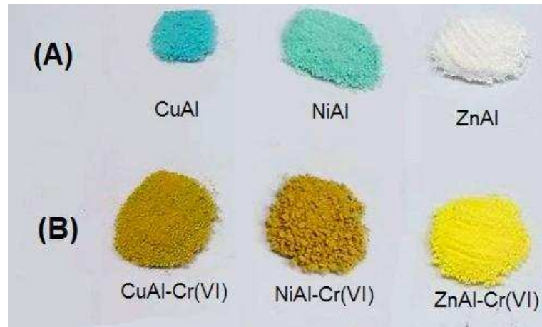
Figura 26. Fotografia dos HDLs obtidos após a reconstrução lamelar com os íons \text{Cu}^{2+} , \text{Ni}^{2+} e \text{Zn}^{2+} . A) na ausência e B) presença de íons \text{Cr(VI)} .
