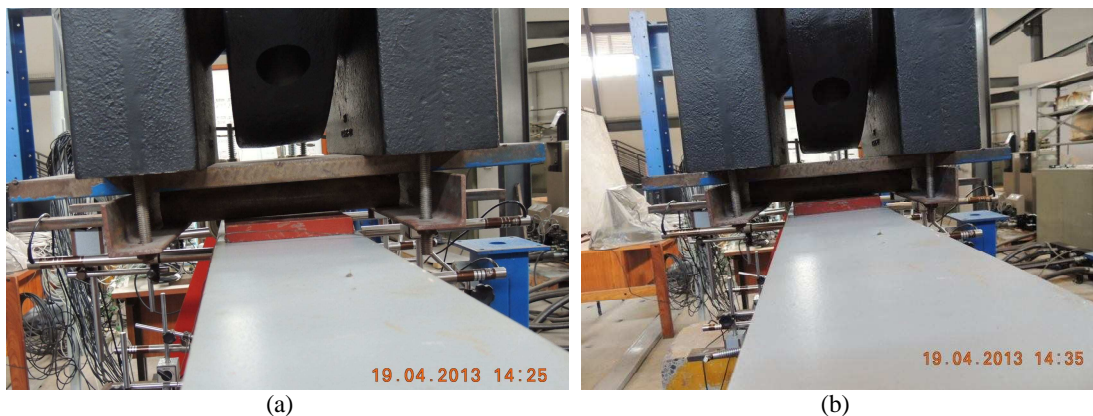
Figura 3.86 – Acomodação do conjunto viga/atuador no ensaio da viga B5: (a) no início do ensaio ( P \approx 50 kN), o eixo do atuador não era ortogonal ao plano da mesa e (b) após a acomodação da do conjunto ( P \approx 220 kN).
