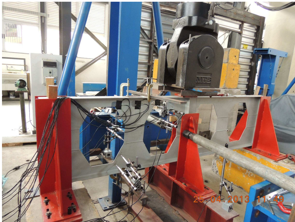
Figura 3.98 – Viga C1, antes do início do ensaio.
