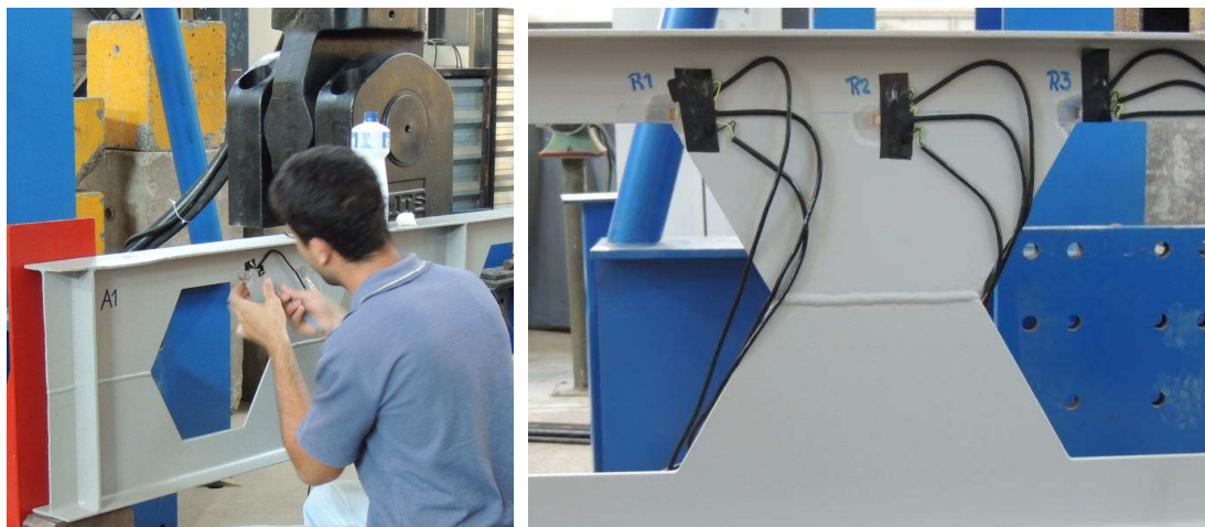
Figura 3.40 – Montagem dos circuitos das rosetas de extensômetros.
