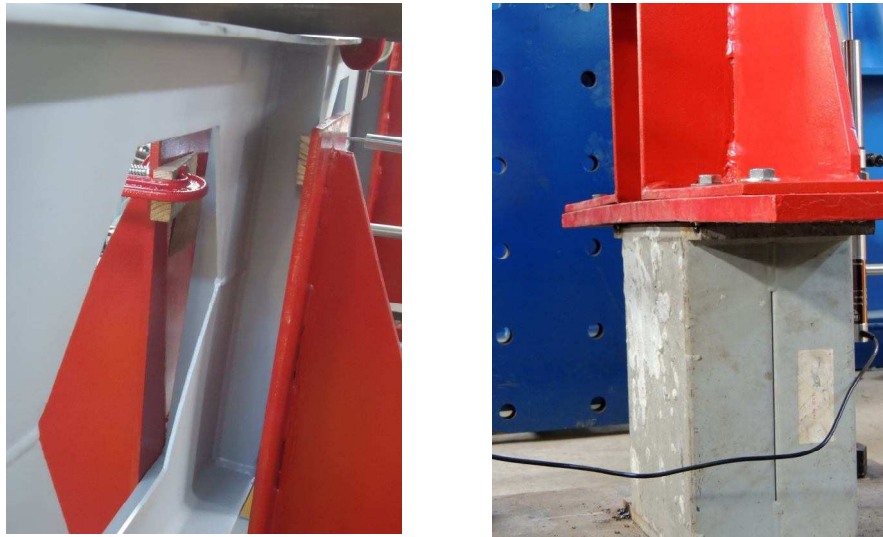
Figura 3.30 – Flexão do vínculo de garfo.
