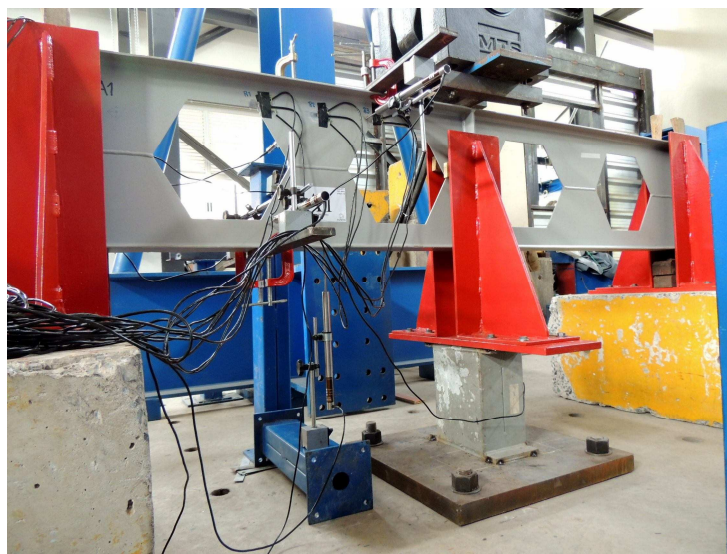
Figura 3.29 – Montagem do ensaio da viga A1.
