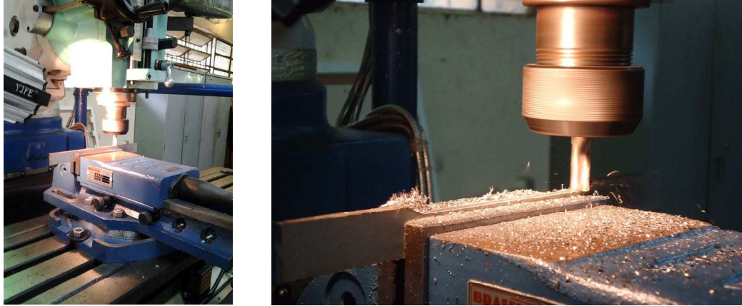
Figura 3.22 – Usinagem de um corpo de prova.
