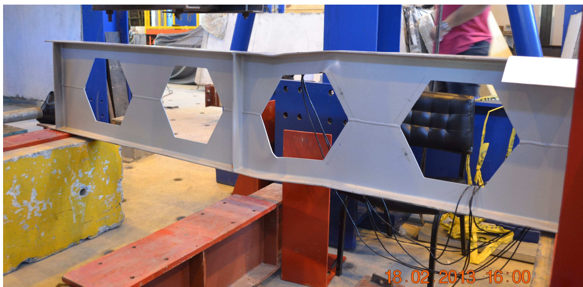
Figura 3.55 – Aspecto da viga A2, após o ensaio (foto: Felipe Sakiyama).
