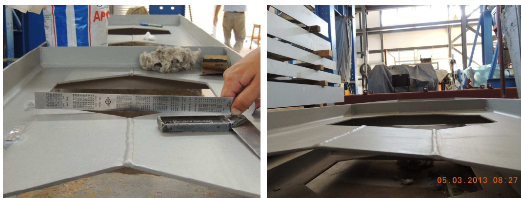
Figura 3.25 – Imperfeições iniciais na viga.
