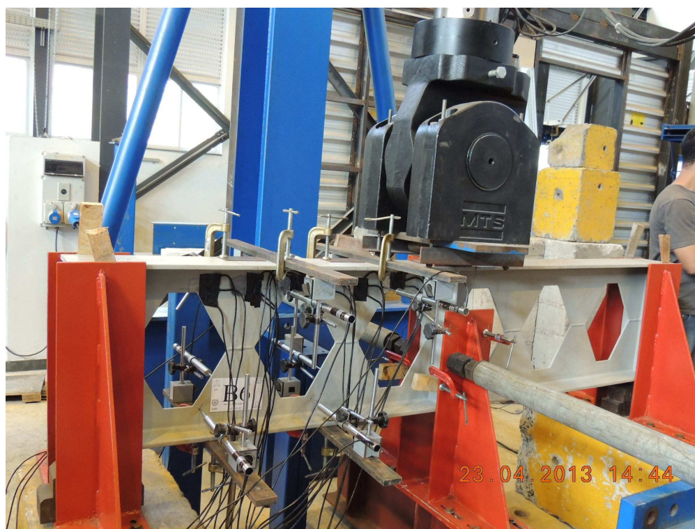
Figura 3.91 – Viga B6, antes do início da FMA.
