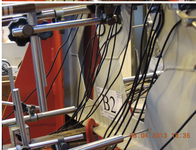
Figura 3.68 – Flambagem dos montantes de alma na viga B2: (a) próximo da carga máxima; (b) próximo ao final do ensaio.
