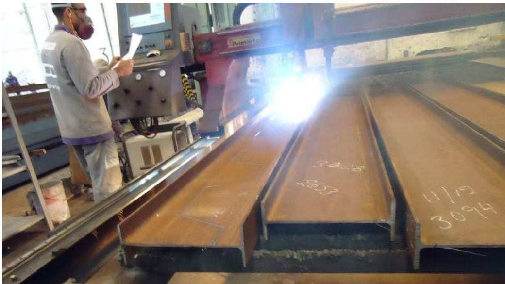
Figura 3.3 – Corte longitudinal com plasma.
