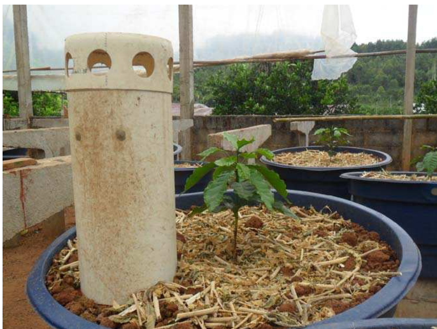
Figura 1. Câmara de volatilização instalada.
