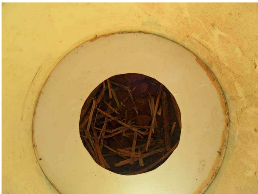
Figura 2. Detalhe do suporte para a espuma no interior da câmara de volatilização.
