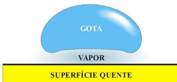
Figura 7 - Representação esquemática do efeito de Leidenfrost: a gota fica “protegida” da superfície quente pela camada de vapor superaquecido.
