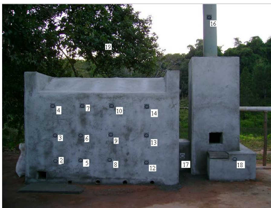
Figura 23a e b - Sistema de aquisição de dados (a) e indicação do posicionamento dos termopares colocados na parede lateral do forno (b).
