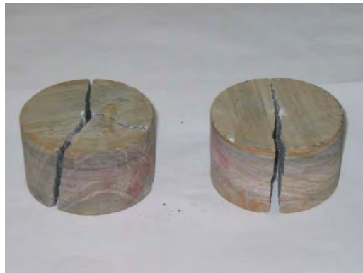
Figura 4.2 – Amostras ilustrando o filito sericítico, obtido a partir de furos de sondagem rotativa, na mina do Tamanduá.
