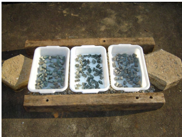
Figura 4.12: Forma de exposição das amostras na ciclagem natural.
