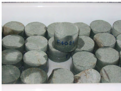
Figura 4.4 – Amostras ilustrando a rocha básica intrusiva, obtidas a partir de furos de sondagem rotativa, na mina do Tamanduá.
