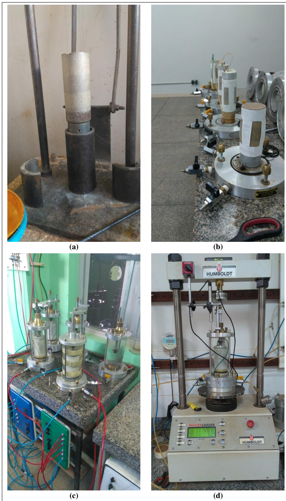
Figura 28 – Etapas do ensaio triaxial realizado sobre corpos de prova (CP) compactados do solo VS: (a) Moldagem de CP; (b) Preparo de CP's para o ensaio; (c) Saturação por contra pressão; (d) Cisalhamento.
