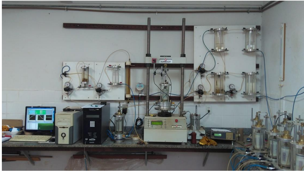
Figura 30 - Célula do ensaio triaxial conectada ao sistema de aquisição de dados.
