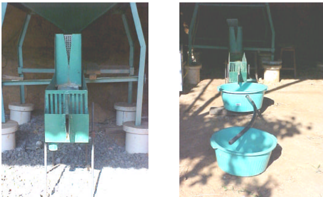
Figura 3 – Sistema de calhas divisorias do tipo Geib para fração de 1/9.
