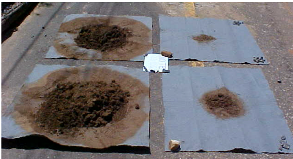
Figura 6 - Manta de bidim que possibilitou a retenção e coleta das partículas de solo transportadas pelo escoamento superficial.
