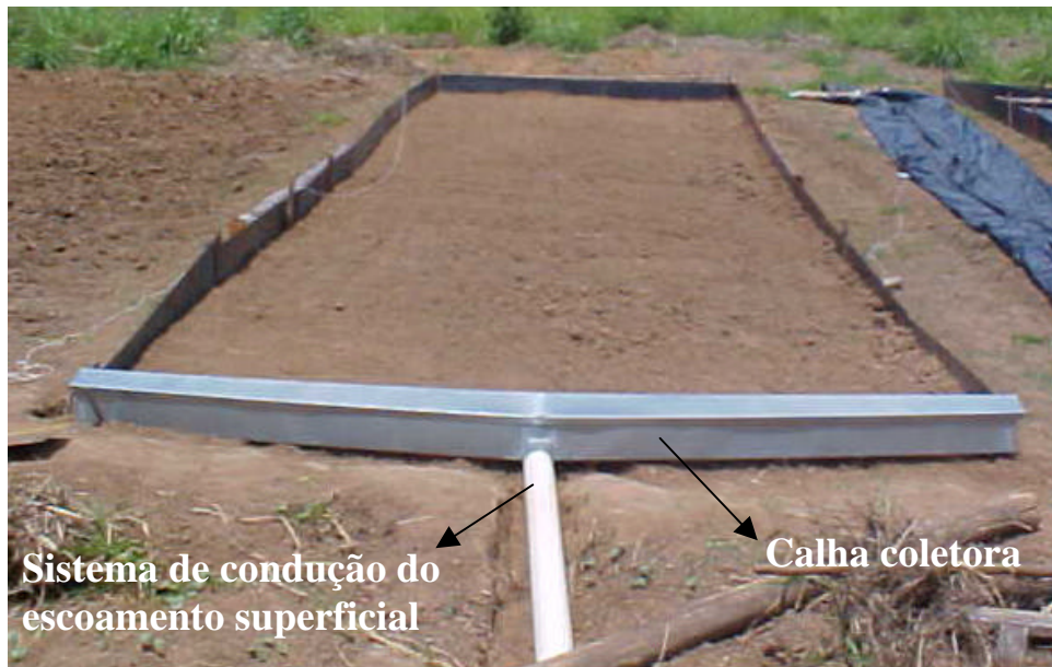
Figura 1 – Parcela experimental utilizada para coleta de dados de perdas de solo e água em Viçosa-MG.
