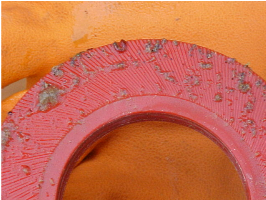
Figura 25 - Detalhe do material causador de entupimento preso nas ranhuras de um dos discos do elemento filtrante.
