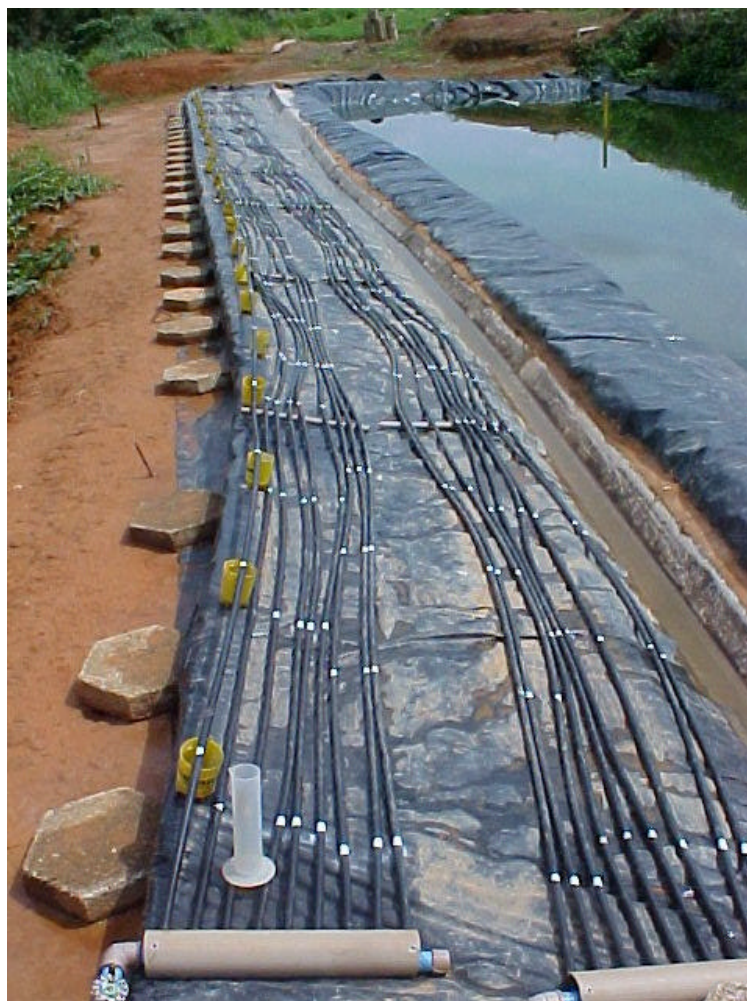
Figura 4 - Vista frontal da avaliação da uniformidade de aplicação de água em uma das unidades de irrigação.
