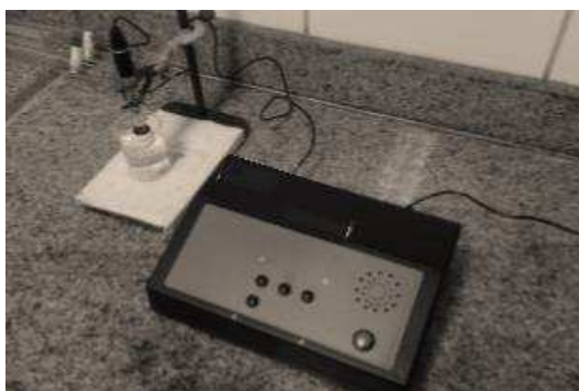
Figura 35. O pHmetro vocalizado desenvolvido pelo grupo de tecnologia assistiva do laboratório de pesquisas em ensino de química e inclusão da UFG.
