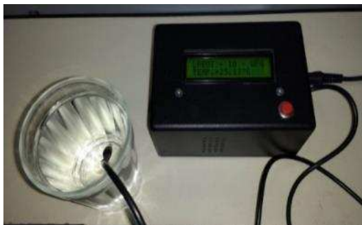
Figura 34. Termômetro vocalizado de laboratório adaptado para DV.
