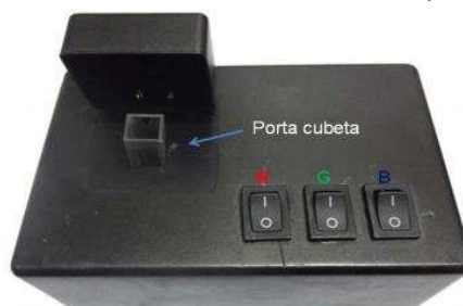
Figura 16. Vista frontal do fotômetro proposto.
