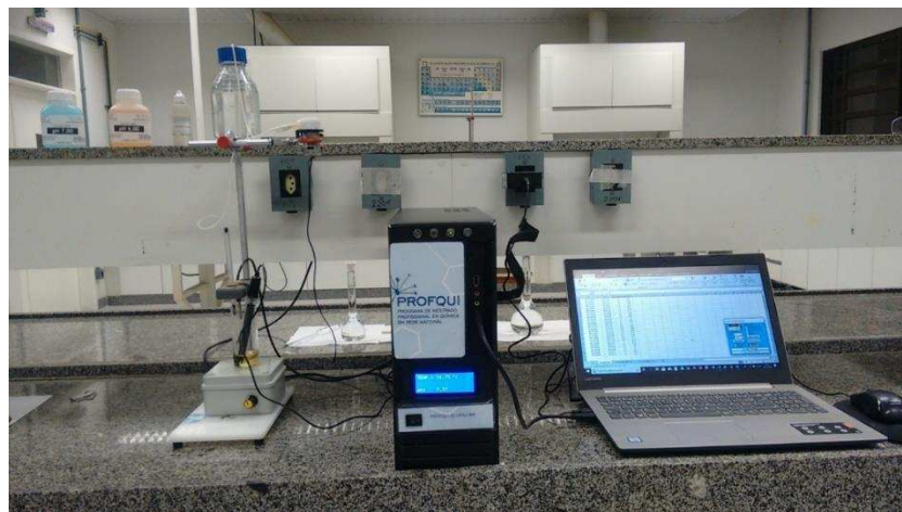
Figura 57. Sistema proposto de titulação potenciométrica automatizada.
