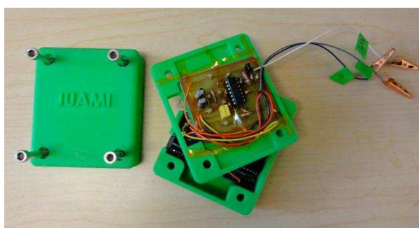
Figura 25. Potenciostato de baixo custo.
