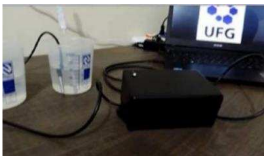
Figura 33. Termômetro vocalizado de laboratório adaptado para DV.
