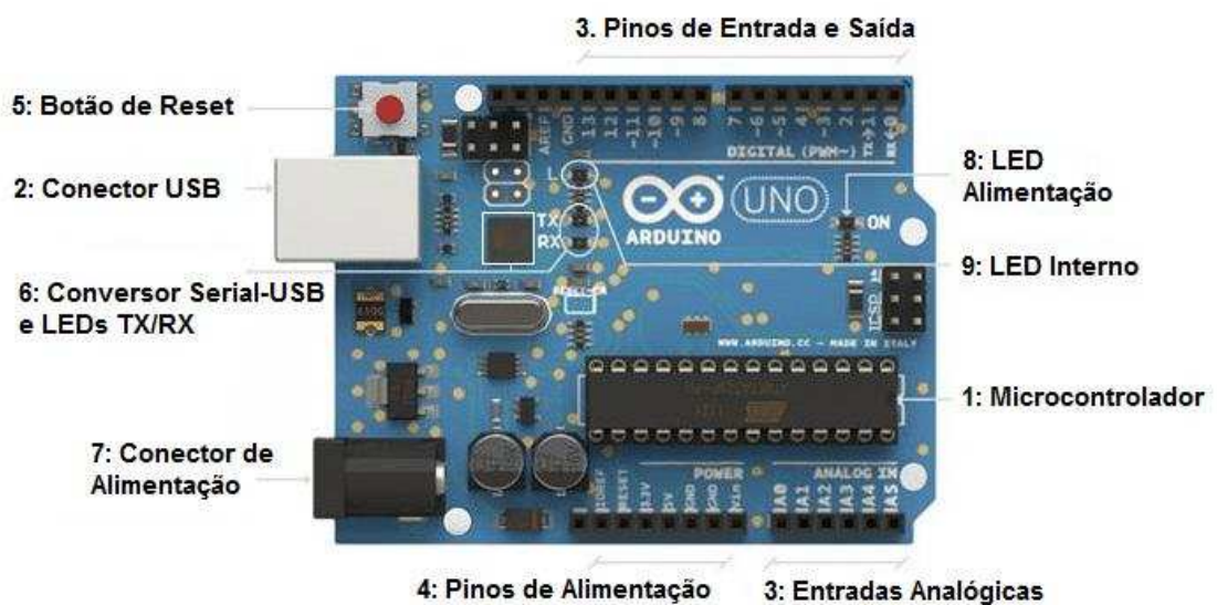
Figura 14. Placa Arduino e seus componentes.
