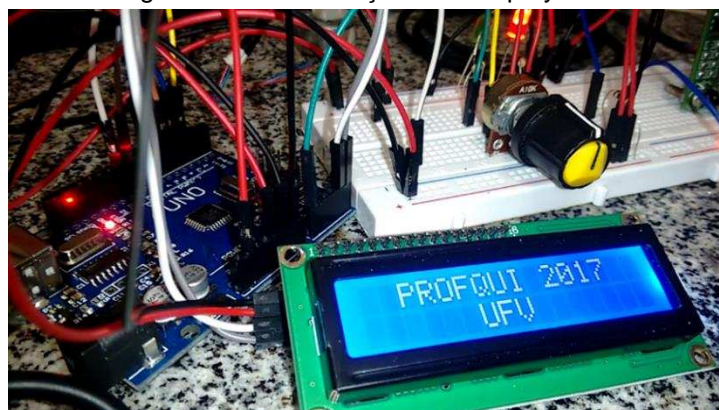
Figura 50. Comunicação com display LCD
