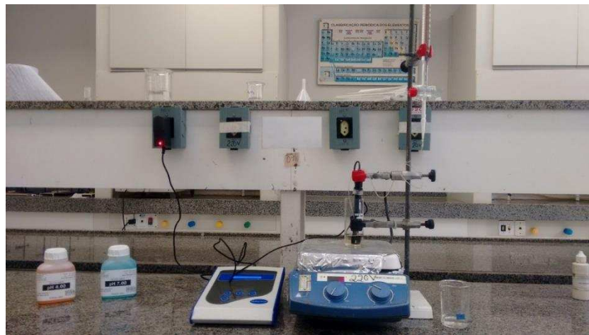
Figura 56. Sistema de titulação potenciométrica convencional.
