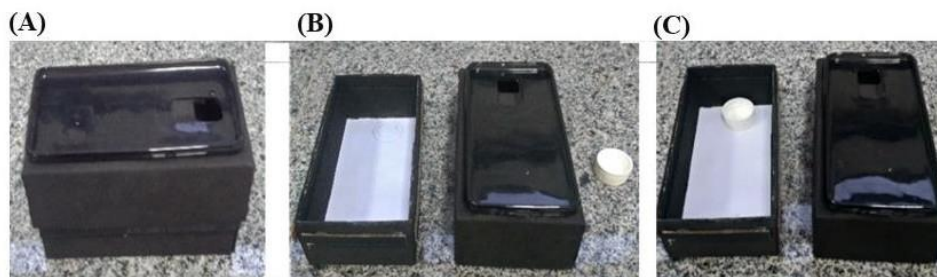
Figura 3. Montagem do espectrofotômetro RGB: (A) Vista externa da caixa suporte para o smartphone, (B) Vista da parte interna, tampa superior e reservatório para amostra, (C) Vista interna com o posicionamento correto do reservatório de amostra.
