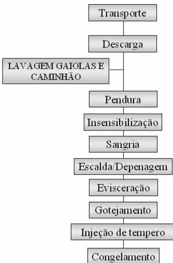
FIGURA 2: Etapas de abate de frango de corte.
