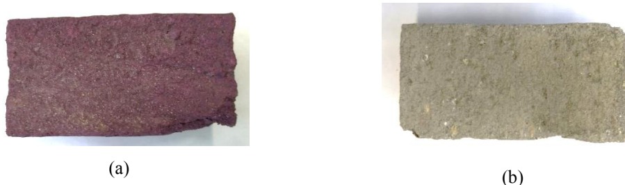
Figura 3.18: Frente de carbonatação para a mistura com solo S2 sob condição de cura 1: (a) momento da troca entre as câmaras; (b) aos 35 dias de cura.
