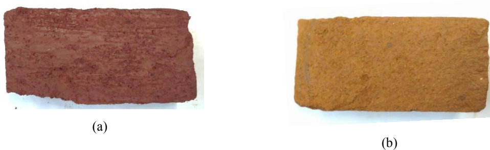
Figura 3.17: Frente de carbonatação para a mistura com solo S1 sob condição de cura 1: (a) momento da troca entre as câmaras; (b) aos 35 dias de cura.
