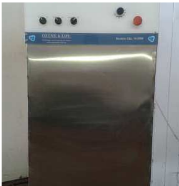
Figura 5.1 - Gerador de ozônio utilizado no tratamento do efluente sintético de laticínios.
