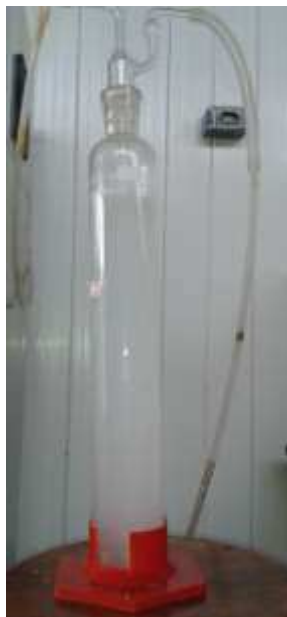
Figura 5.2 - Frasco lavador que foi utilizado para o processo de flotação/ozonização do efluente sintético e bruto de laticínios.
