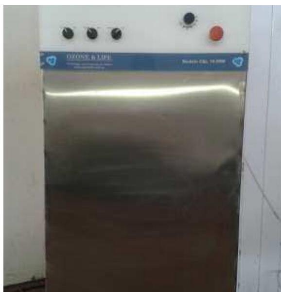
Figura 4.1 - Gerador de ozônio utilizado no tratamento do efluente sintético de laticínios.
