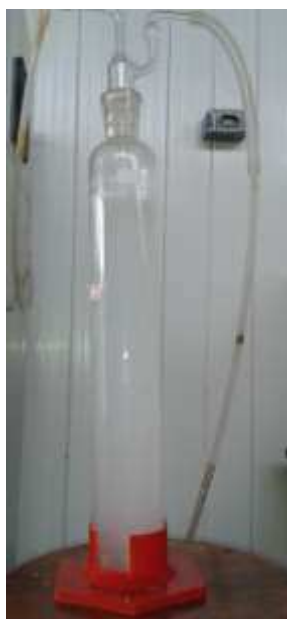
Figura 4.2 - Frasco lavador que foi utilizado para o processo de ozonização do efluente sintético de laticínios.
