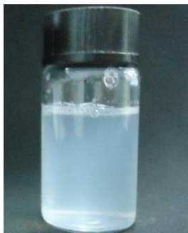
Figura 11: NPQ dispersas em água, em concentração de 1% (m/v) após centrifugação e agitação ultrassônica.
