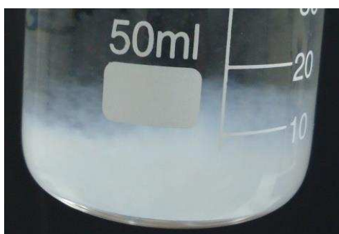
Figura 6: Suspensão opalescente com nanopartículas aglomeradas e sedimentadas, na razão de massa de QT:TPP em 1:1.
