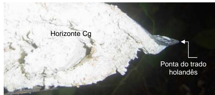
Figura 25 – Horizonte de gleização Cg de mosqueado cinzento-claro e branco, textura argilo-arenosa (termo regional: batinga ou tabatinga).
