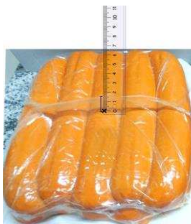
Figura 2: Esquema utilizado para quantificar o desprendimento da embalagem.
