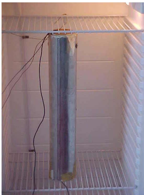
Figura 8A – Visão interna da “B.O.D.” e do equipamento utilizado para determinação das propriedades térmicas do produto.
