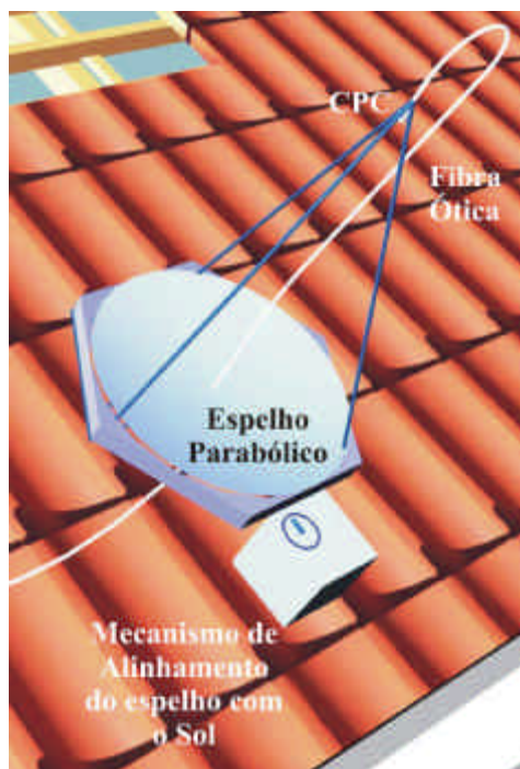
Figura 39 – Detalhe mostrando o espelho, os apoios e suportes, a fibra ótica e o concentrador parabólico composto (CPC).
