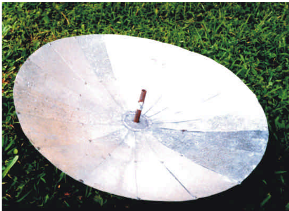
Figura 23 – Teste de confecção do espelho parabólico, conforme procedimento descrito na metodologia.
