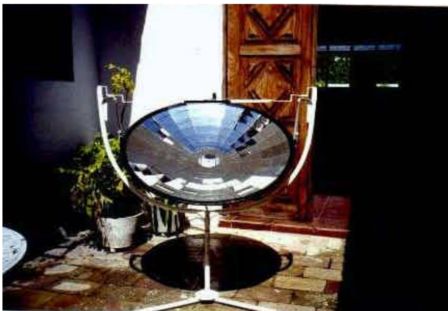
Figura 13 – Fogão solar do tipo concentrador parabólico (BEZERRA, 1998).
