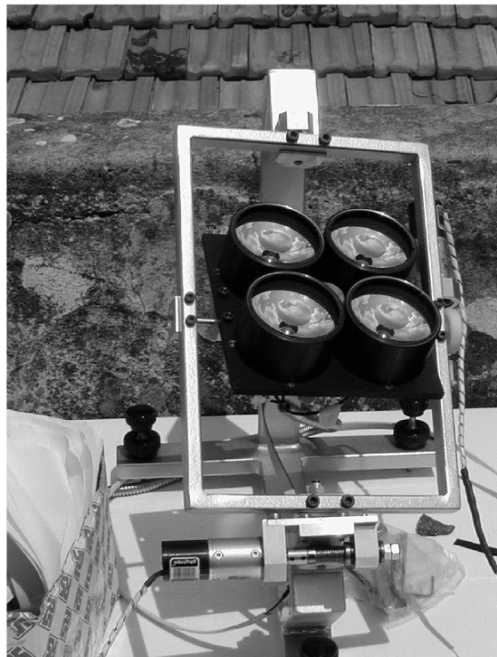
Figura 10 – Sistema de localização solar, disposto em suporte contendo quatro concentradores.
