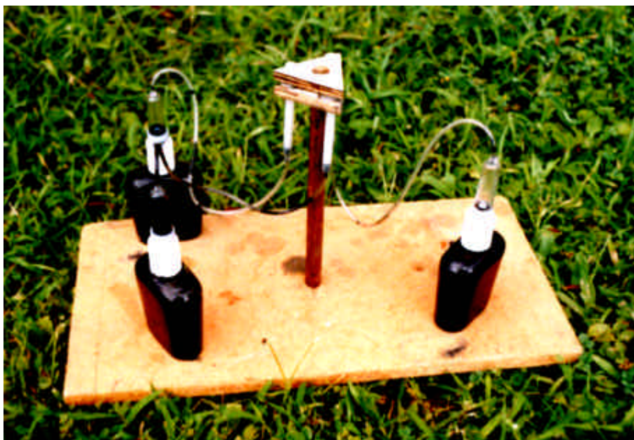
Figura 30 – Montagem de um rastreador solar passivo.
