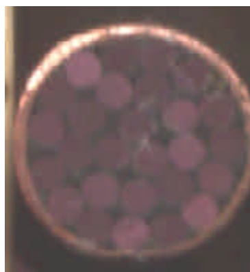
Figura 32 – Extremidade do cabo ótico.
