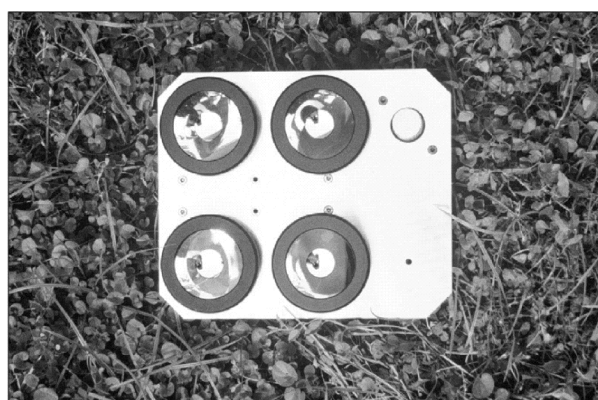
Figura 6 – A plataforma com o rastreador solar e quatro nichos de lentes. (CIAMBERLNI et al., 2003).
