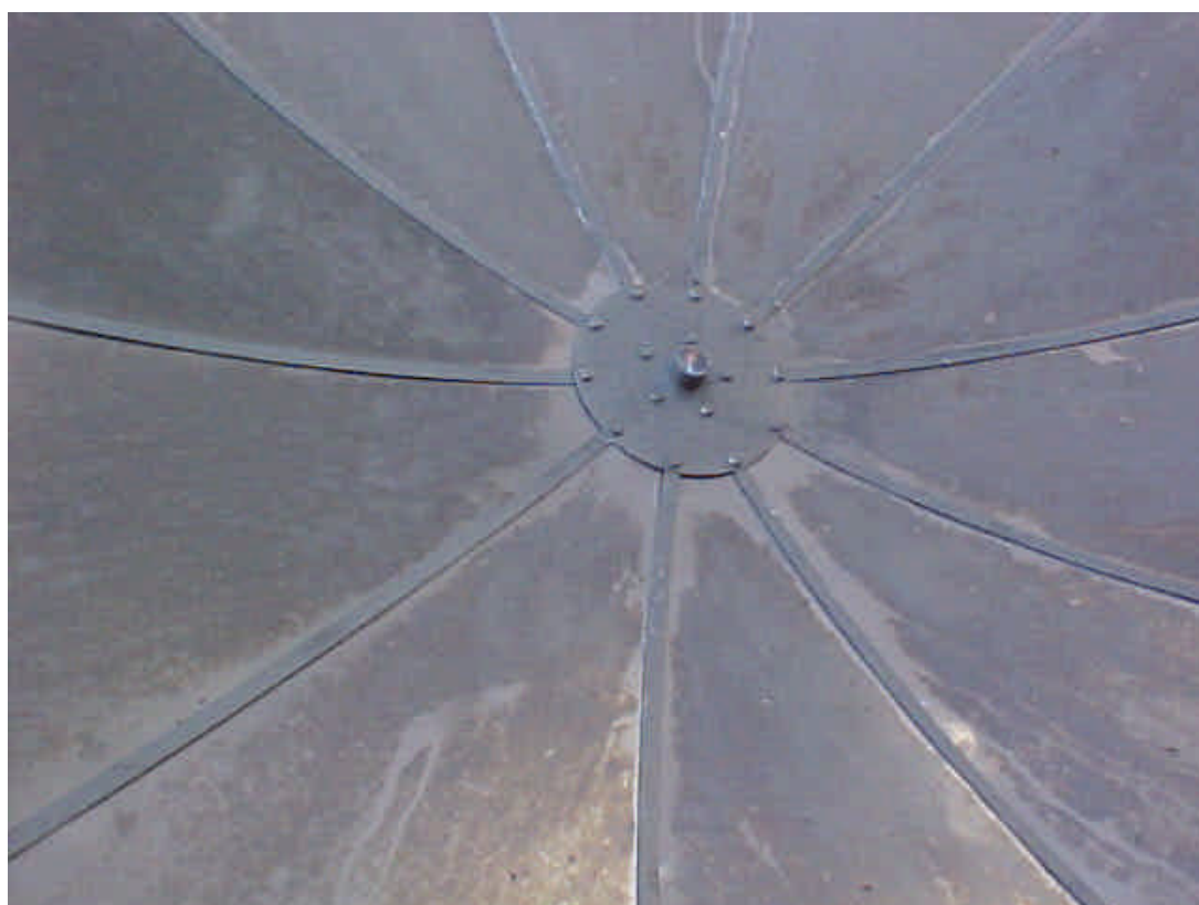
Figura 26 – Superfície do refletor após seis meses de exposição às condições meteorológicas de Viçosa (agosto de 2003 a fevereiro de 2004).
