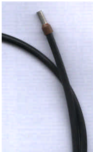
Figura 31 – Detalhe do cabo ótico de 2 m de comprimento.
