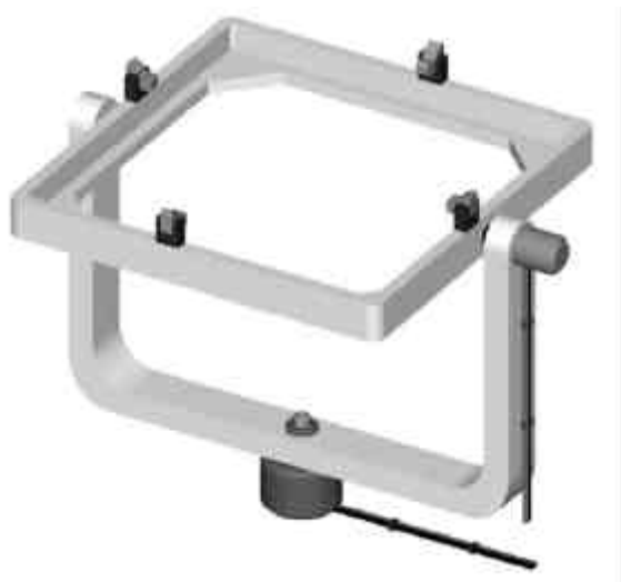
Figura 5 – Exemplo de suporte utilizado para fixar os painéis coletores de radiação.
