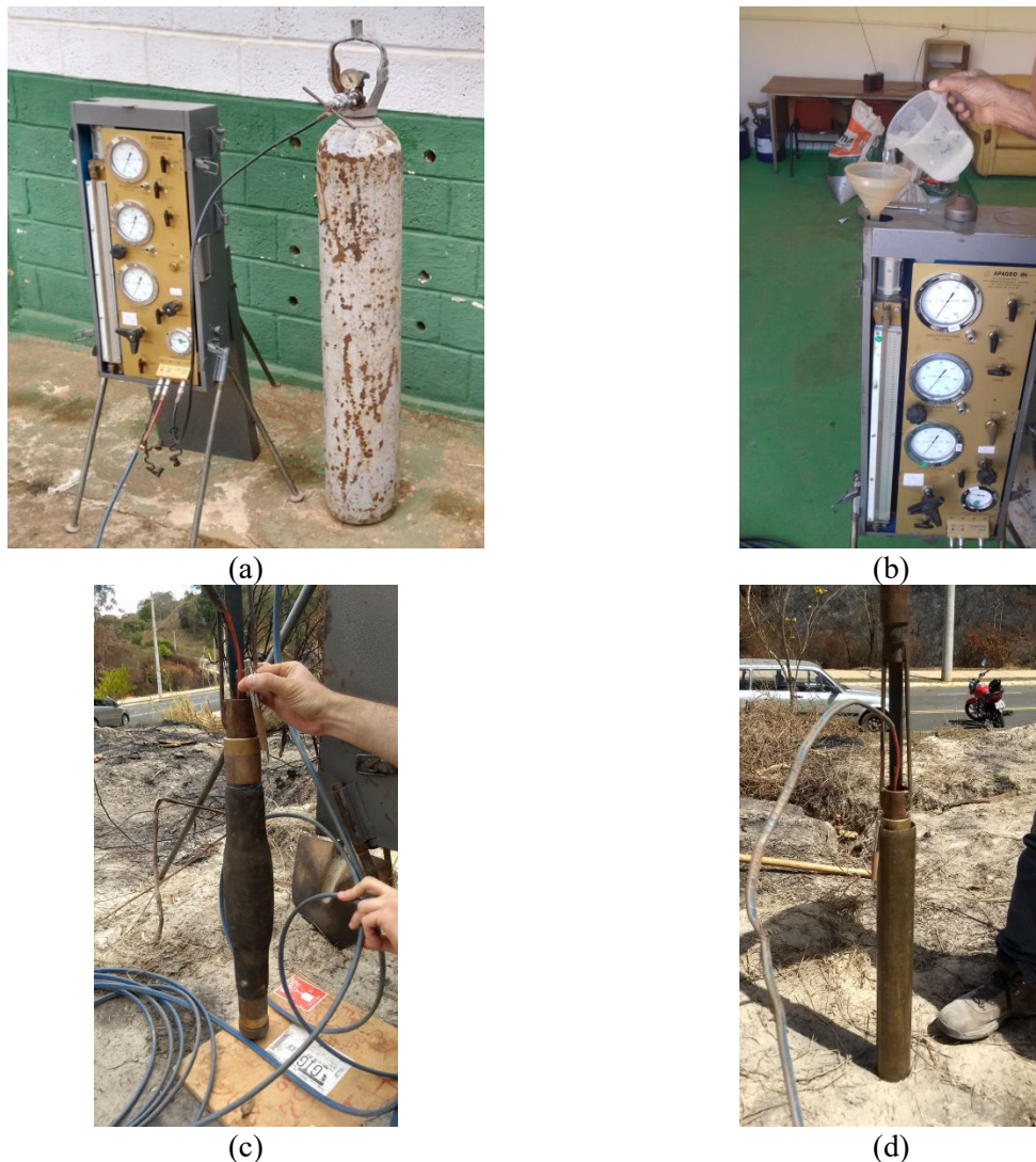
Figura 25 - Pressiômetro de Ménard: a) unidade de controle e fonte de pressão, b) saturação do equipamento, c) calibração por perda de pressão e d) calibração por perda de volume.
