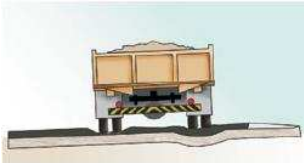
Figura 2.2 – Deformações permanentes em pavimentos asfálticos
