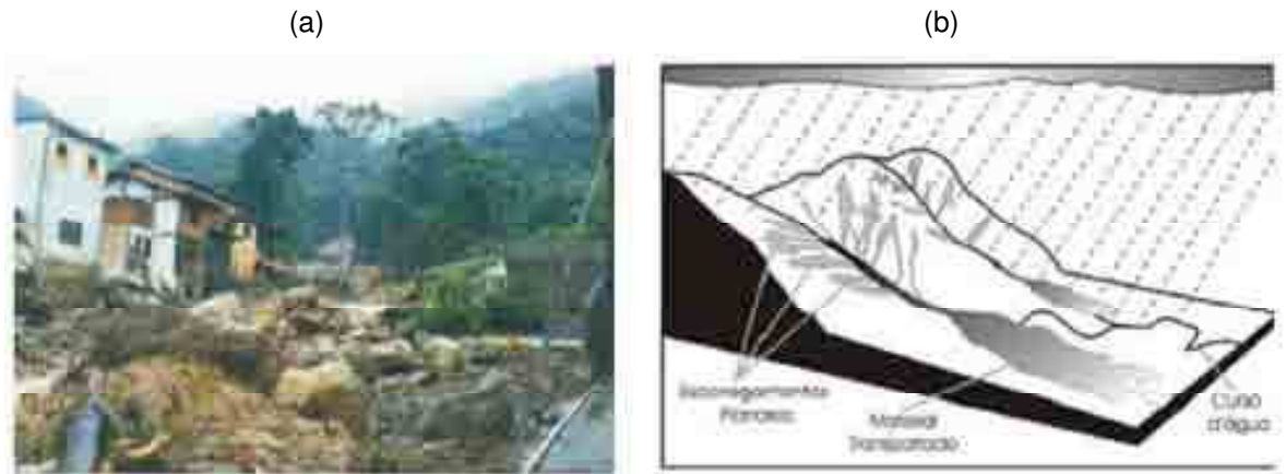
Figura 2.3 – (a) Acidente associado ao processo de corrida; (b) Perfil esquemático de processo do tipo de corrida.
