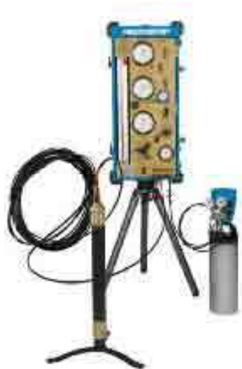
Figura 2.7 – Pressiômetro de Ménard, tipo GC (APAGEO)
