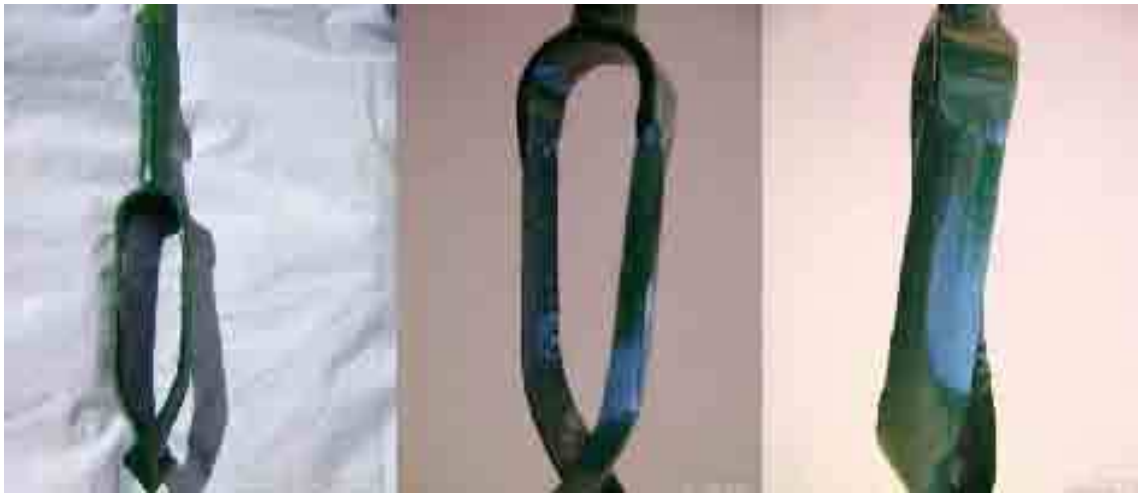
Figura 3.2 – Trado tipo cavadeira cônica, padrão holandês
