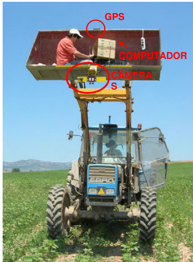
Figura 1 – Sistema de visão artificial com as câmeras, microcomputador e o GPS, acoplados na pá do trator, em operação pela área em estudo.
