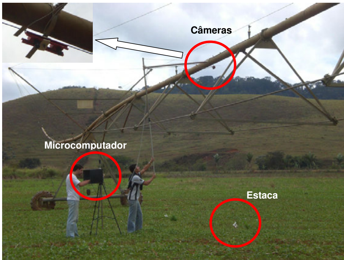
Figura 1 – Sistema de visão artificial com as câmeras, microcomputador e um exemplo do ponto de referência (estaca).
