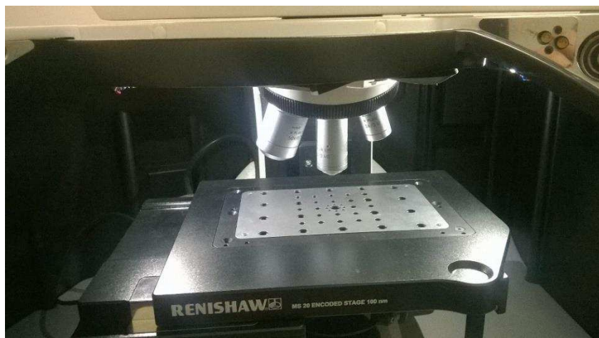
Figura 3.7 – Visão do estágio motorizado onde eram feitos os depósitos. São vistas três lentes logo acima do estágio. São lentes de intensificação 50X, 20X e 5X, respectivamente. Os depósitos foram feitos com a lente de 20X.
