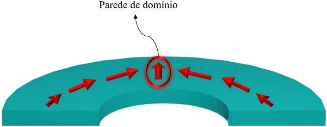
Figura 2.2 – Parede de domínio modelada como um elipsoide uniformemente magnetizado, cuja orientação da magnetização obedece à do centro da parede.
