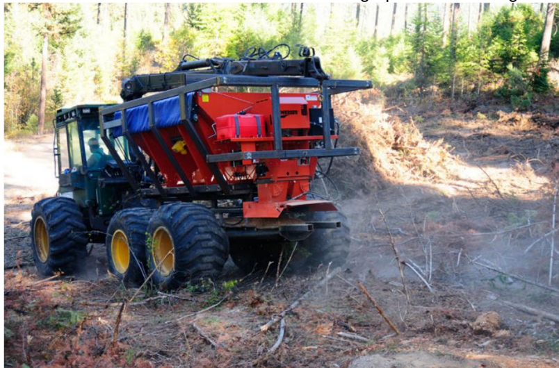
Figura 4 - Trator florestal Forwarder com distribuidor centrífugo para carvão vegetal fino
