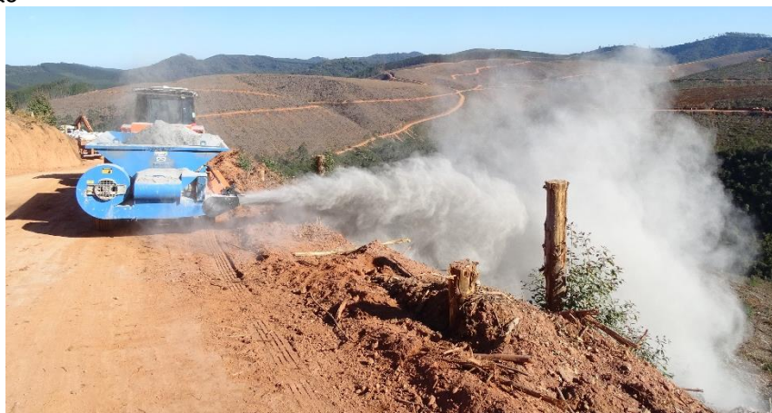
Figura 12 – Exemplo de distribuidor de calcário pneumático com deslocamento em estrada e aplicação dentro do talhão
