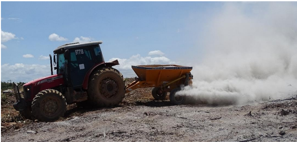
Figura 10 - Distribuidor de calcário de arraste com discos centrífugos realizando aplicação em área florestal
