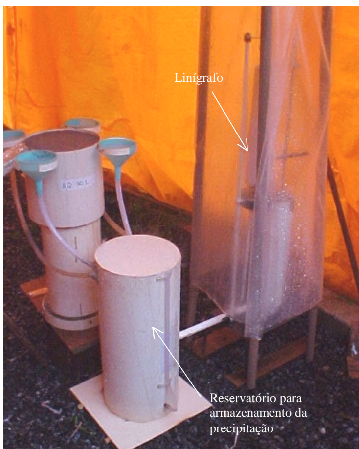
Figura 3.5. Reservatório de armazenamento da precipitação e linígrafo utilizados na realização do experimento.
