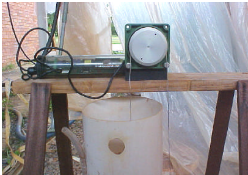
Figura 3.4. Medidor de nível (Thalimedes) utilizado no experimento.
