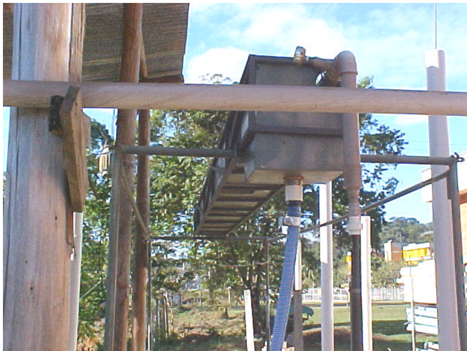
Figura 3.2. Simulador de chuvas utilizado no experimento.
