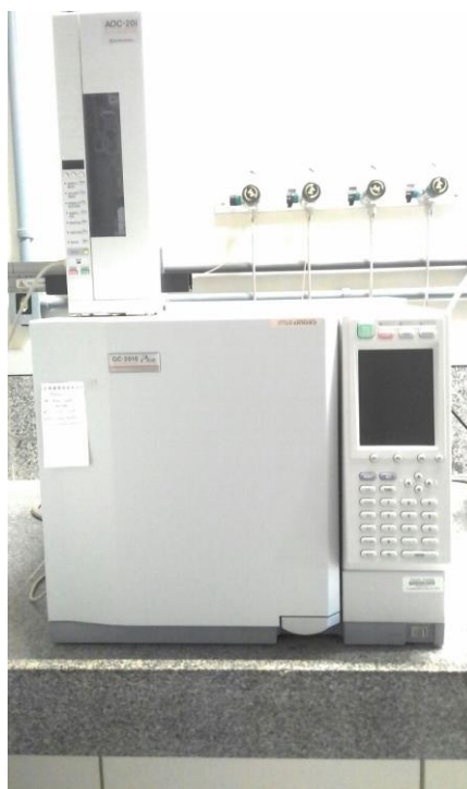
Figura 23: Cromatógrafo equipado com detector FID utilizado.
