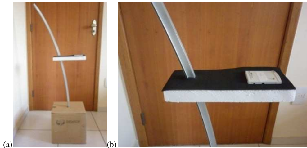
Figura 2.3 - (a) Suporte 2; (b) Material EVA preto ao redor do recorte onde se encaixa o registrador de iluminâncias.
