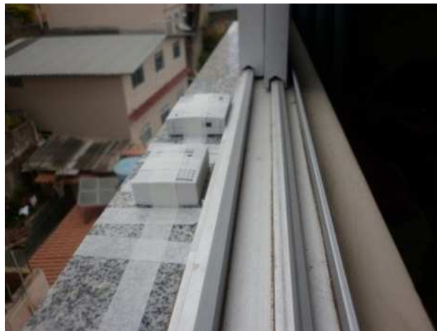
Figura 2.9- Medições externas: registradores posicionados no centro do peitoril da janela do quarto 2.
